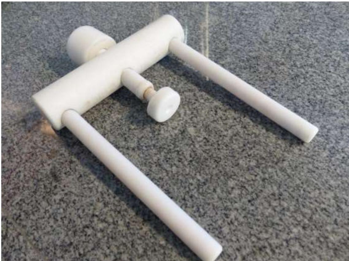
A Figura 3 mostra a vista inferior do dispositivo produzido, testado e utilizado na precipitação dos polímeros sulfonados no Laboratório 209 no Centro de Tecnologias Limpas da Feevale.
